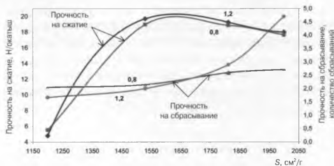
Рис. 1. Влияние удельной поверхности концентрата на качественные показатели сырых окатышей (цифры у кривых — количество бентонита, мас. %)
